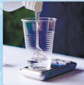
**3.** Miscelare la resina epossidica seguendo il **rapporto di miscelazione 100:66** (in peso): **42 g di A e 28 g di B** per coprire 2 sottobicchieri rotondi e 2 quadrati. **Pesare e miscelare accuratamente** entrambi i componenti per 3 minuti, assicurandosi che tutti i lati e il fondo del contenitore di miscelazione siano compresi per una miscelazione efficace. Lasciare riposare il composto per 2-3 minuti.
